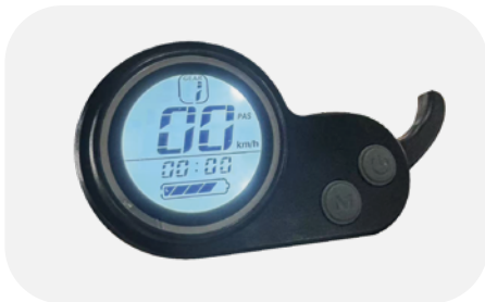
Multifunkční displej / akcelerátor / přepínač / indikátor nabité baterie
