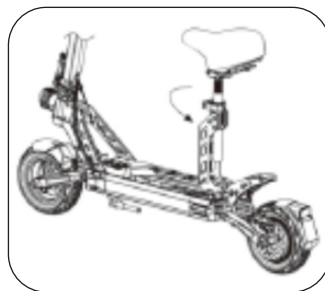
3. Uzamknite zámok sedla a skontrolujte kolobežku.
