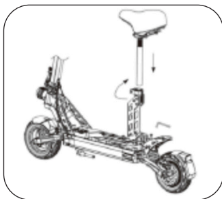
2. Pripevnite sedlový stĺpik pomocou skrutiek, vložte sedlo do držáka a nastavte výšku.
