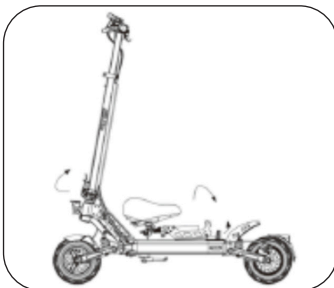
2. Upevnite skladací mechanizmus, zdvihnite držiak sedla, potiahnite a zaistíte rýchlopínacie zariadenie sedla.
