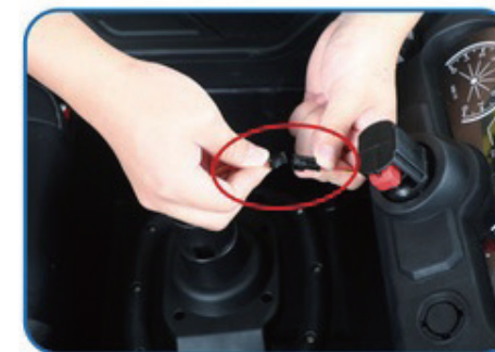
4. Připojte volant napájecím kabelem
