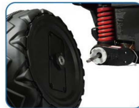
18. Zamontuj tylne koło na osi
