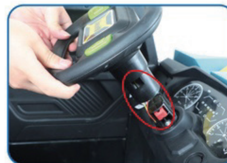
5. Porovnajete drážky a zacvaknite volant
