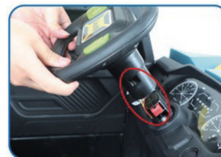
5. Srovnejte drážky a zacvakněte volant
