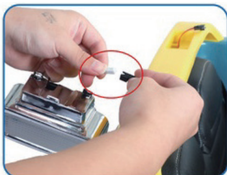
9. Podłącz kabel zasilający tylne światło
