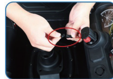
4. Pripojte volant napájacím káblom
